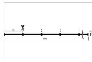
Qualityflex COB vision. . Fassung: ohne, Schutzart: nach DIN EN 60529: IP00, Schutzklasse: (EN 61140) III, Spannung: 24V, Leistung: 50W, Farbtemperatur: 4000K, Abstrahlwinkel: 180°, .
