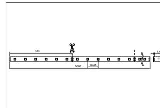
QualityFlex PEFORMANCE, LED-Weißlicht, 3000K, CRI > 95. Länge: 20000.0 mm Lampenleistung je Meter: 5.0 W/m, Lichtstrom je Meter: 410.0 lm/m, Schutzart: IP00, Schutzklasse: III, Spannung: 24V DC, Abstrahlwinkel: 120.0 °, 60 LEDs pro Meter, Chip-Abstand (Short Pitch) : 16,66mm. Zur Individuellen Anwendung kann die LED-Flexplatine alle 100 mm eingekürzt werden. Die Maximale Systemlänge von 20.000mm darf mit einer Einspeisung nicht überschritten werden.
