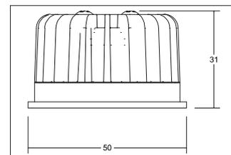
LED-Einsatz DISC, MR16, 6 W, mit Linsenoptik, rund. Ausführung: Plug&Play, Material: Aluminium / Kunststoff, Schutzart: nach DIN EN 60529: IP20, Schutzklasse: (EN 61140) III, Leistung: 6W, Anzahl der Leuchtmittel / Fassungen: 1.0 Stk, Lichtstrom: 640lm, Farbtemperatur: 3000 K, Abstrahlwinkel: 18°.
