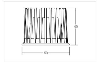
LED-Reflektoreinsatz MR16, 3 W, weiß, rund. . Fassung: Plug&Play, Material: Aluminium / Glas, Schutzart: nach DIN EN 60529: IP20, Schutzklasse: (EN 61140) III, Strom: 350 mA, Leistung: 3W, Lichtstrom: 310lm, Farbtemperatur: 3000K, Abstrahlwinkel: 38°, .
