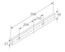
Tiefenanpassung des Filterauszuges bis 29 mm möglich Maße in mm
